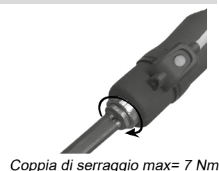
Coppia di serraggio max= 7 Nm
